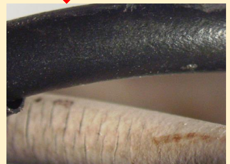
※器具内の劣化した電線の亀裂（拡大画像）
